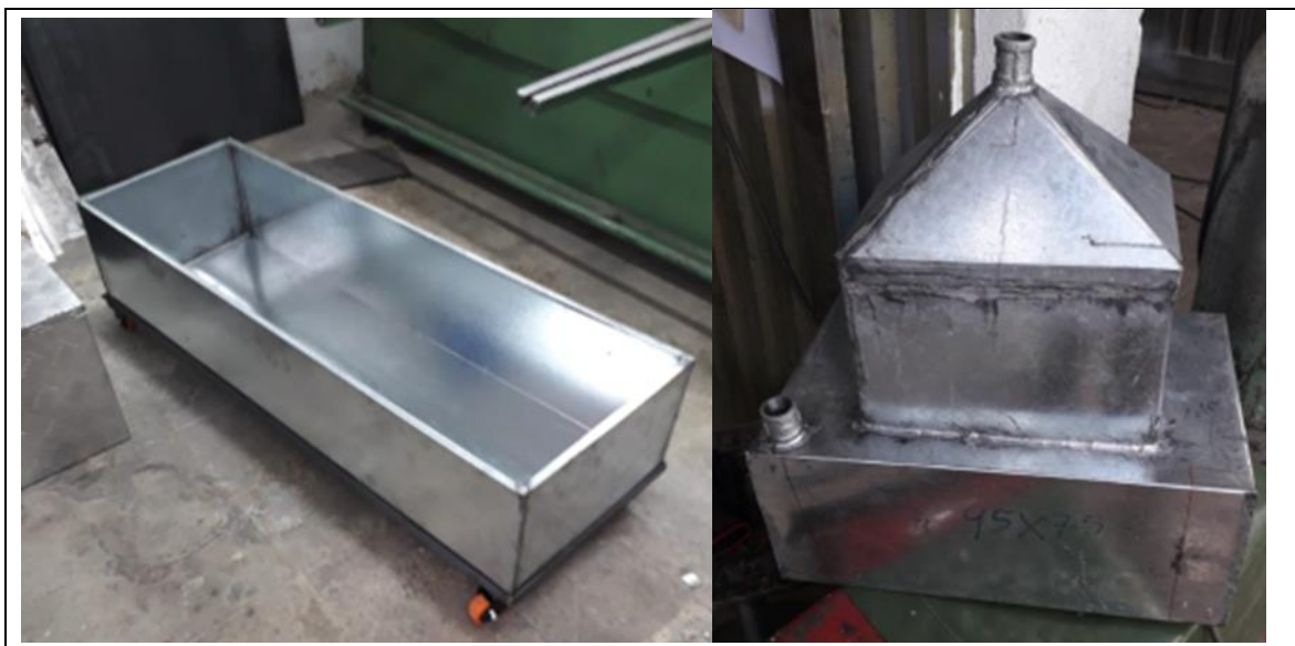
Figura 14 Tanque de almacenamiento, abastecimiento y rebosadero.
