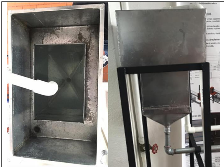
Figura 18 Tanque de rebosadero instalado.
