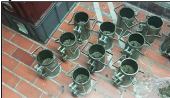
Figura 10. Elaboración de muestras de concreto
