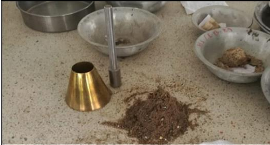
Figura 6. Ensayo de Cono para Determinar Condición Superficialmente Seca
