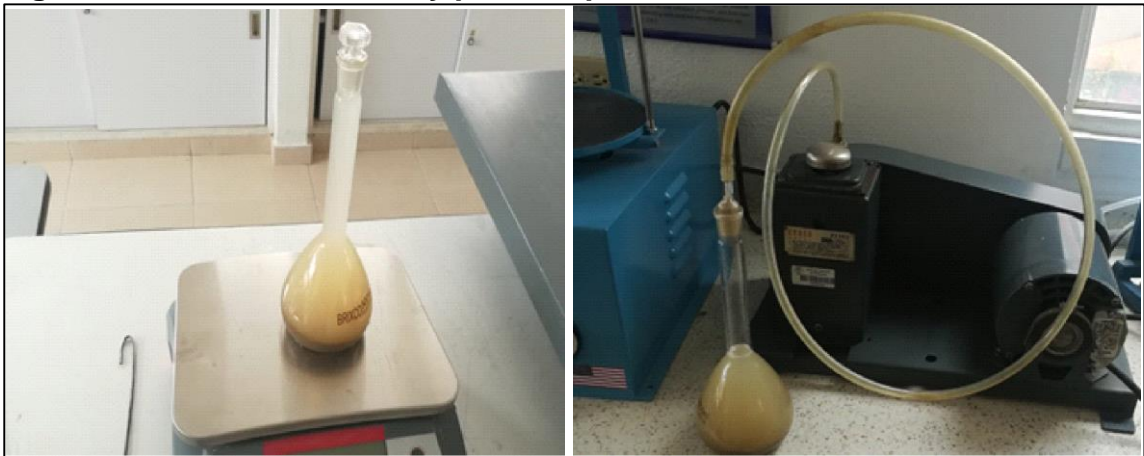
Figura 7. Extracción de aire y peso de picnómetro más muestra.
