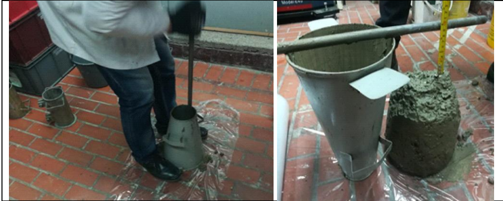
Figura 9. Ensayo de asentamiento del concreto
