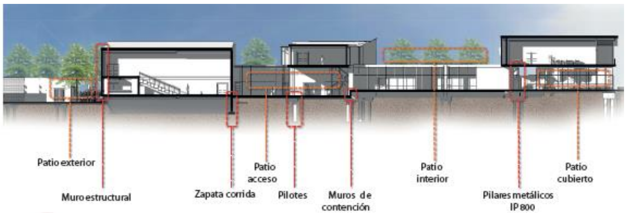
Ilustración 18: Sistema estructural metálico completo
