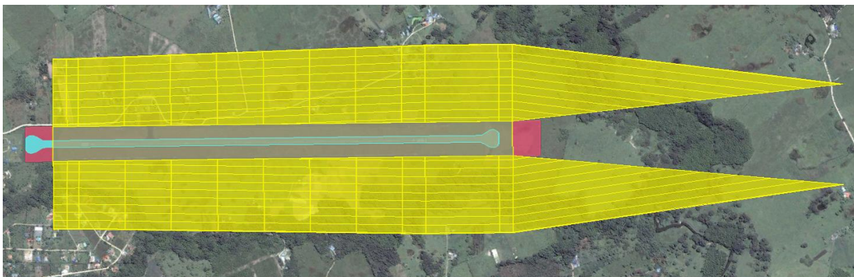
Figura 2-10. Superficie de transición RWY SUR
