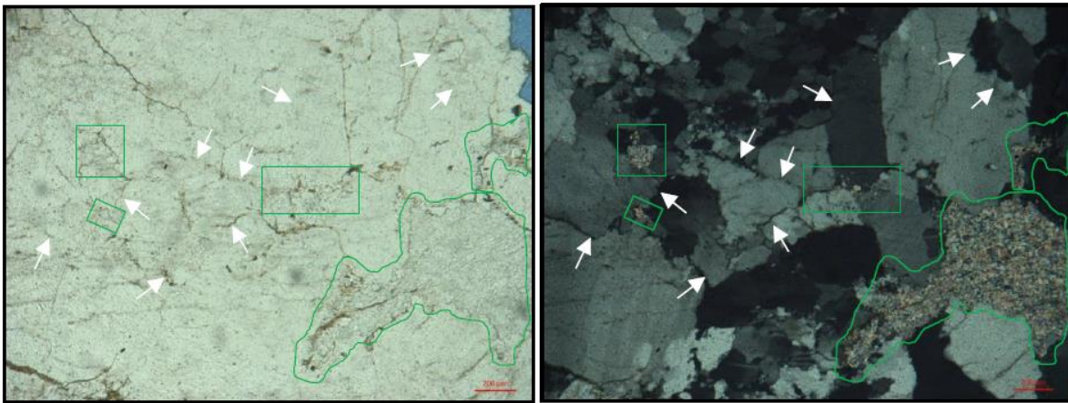
Figura 4-5. Sección delgada Roca tipo III. Arenisca cuarzosa-lítica. Fuente: Reporte de análisis petrográfico y mineralógico por DRX.
