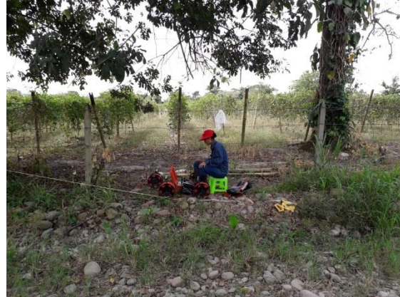
Fotografía 8-13 Sondeo eléctrico vertical N° 4 vía veredal
