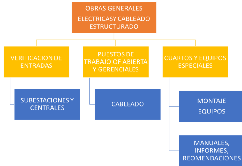
Formato 15: Etapa 2. EDT Obras Eléctricas y Cableado estructurado
