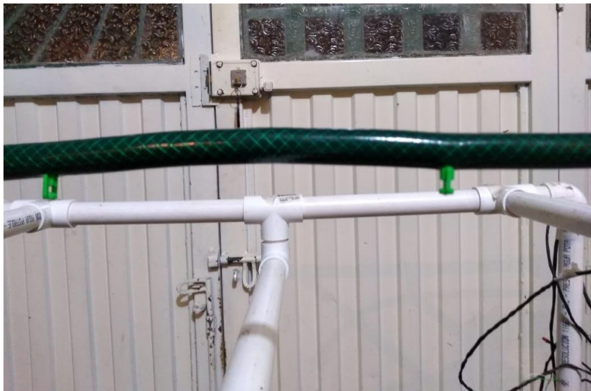
Figura 23. Micro-aspersores implementados en la manguera.
