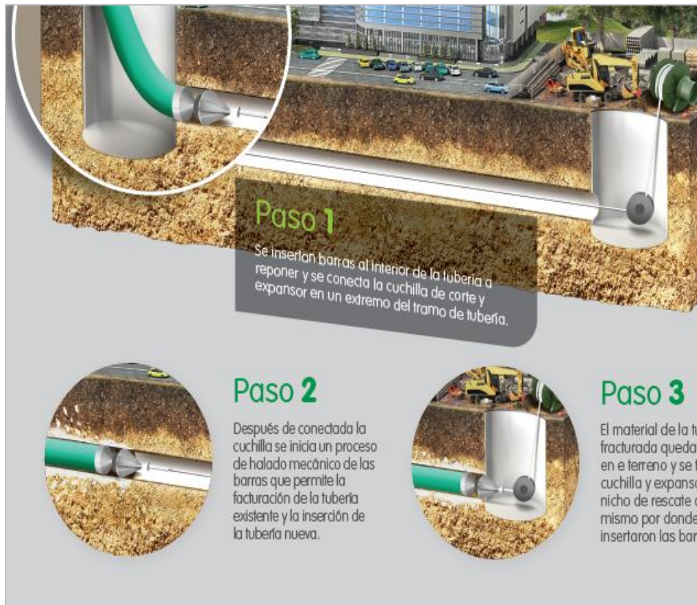
Figura 3. Paso a paso tecnología Pipe Bursting
