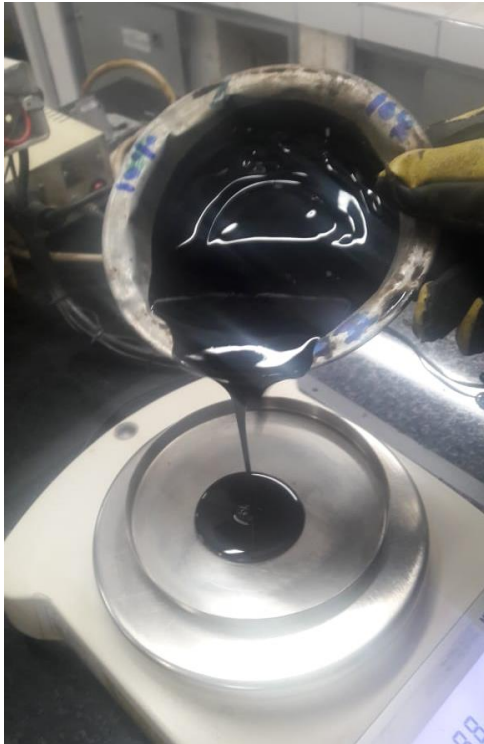
Foto 5 Preparación muestras para el DSR
