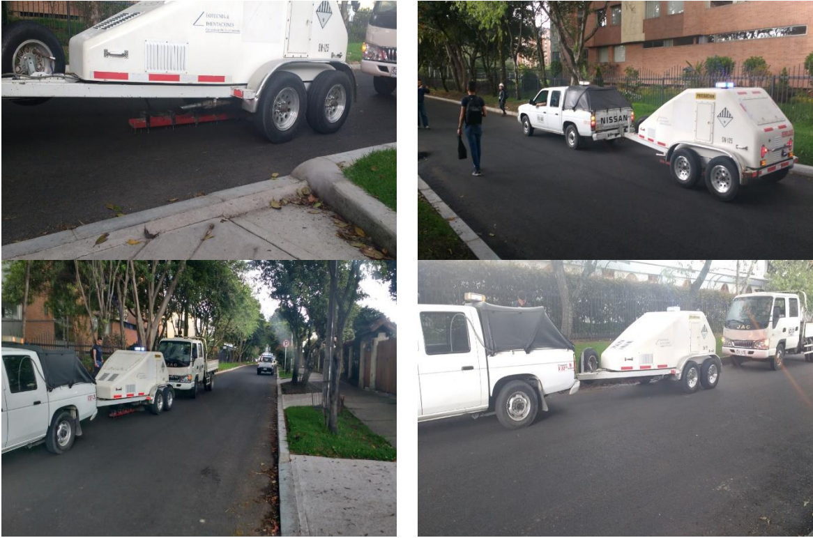
Ilustración 18 Fotografías toma de datos del ensayo FWD.
