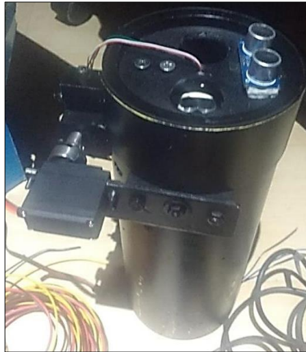
Figura 42. Entrada del sistema con los elementos de control acoplados
