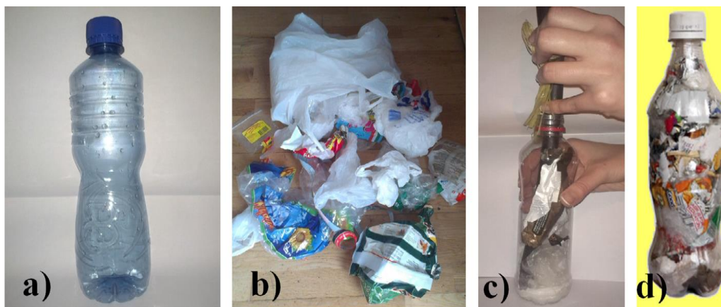
Figura 10. Desarrollo de Eco-ladrillos a través de la recolección de botellas de PET.
