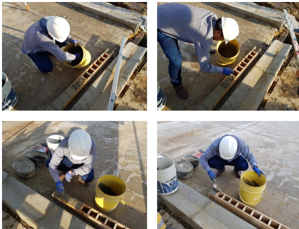
Figura 22. Elaboración de probetas según dosificaciones.
