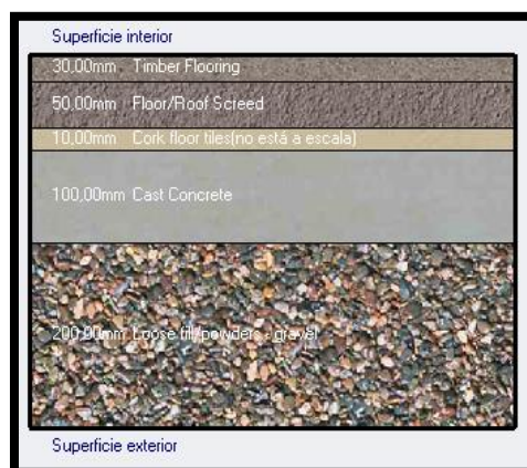
Figura 57. Composición de la placa de contrapiso.
