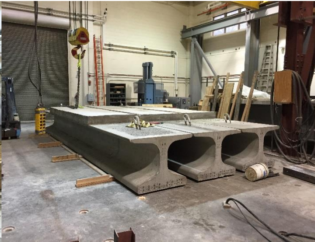
(d) Demolded Concrete Deck
