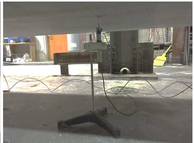
(d) LVDT Below Girder at Midspan
