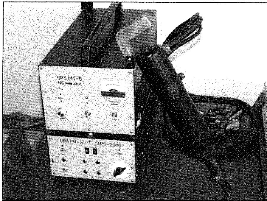
Figure 2.2. 27 kHz UIT generator and application tool (Lihavainen et al. 2003).
