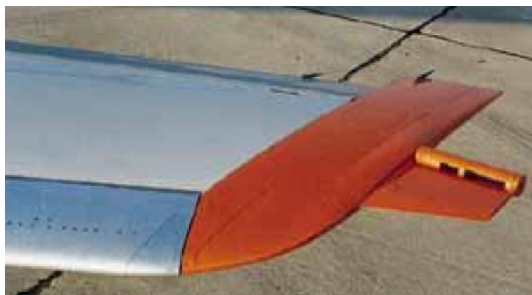
Figure 1.2 - DEI Flutter Vane - Rotating Cylinder 5
