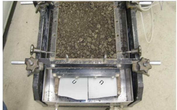
(d) Placing RAP inside the upper box and then compacting
