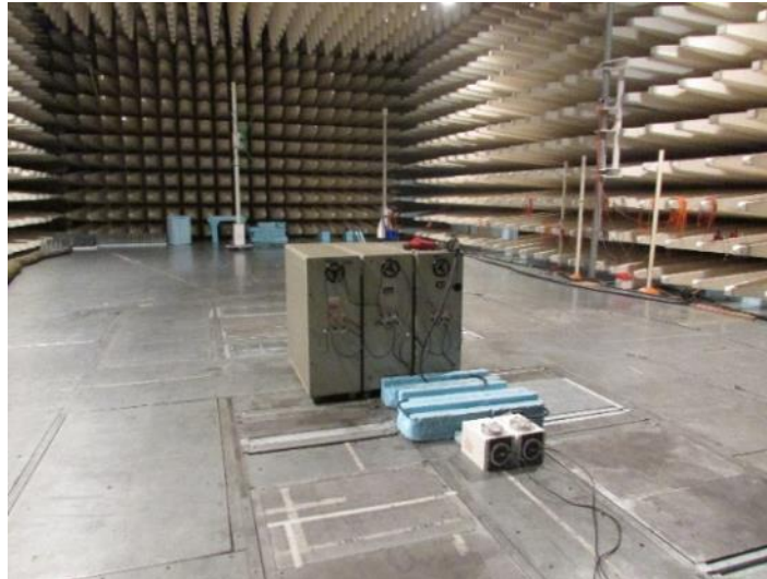
Bild 4: Messaufbau gestrahlte Emissionsmessung
