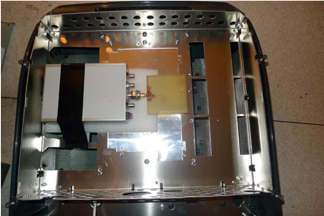
**Bild 5:** Gerätegehäuse mit Kammgenerator zur Bestimmung der Schirmdämpfung
