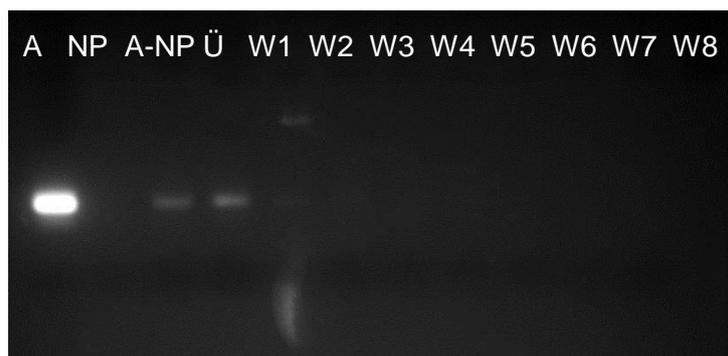
Abbildung 46: Agarose-Gelelektrophorese von Syl3C-PAA@FeWT funktionalisierten NP. A=reines Aptamer; NP=PAA@FeWT; A-NP=Syl3C-PAA@FeWT nach Aufreinigung; Ü=Überstand; W1-8=Waschschrirte.
