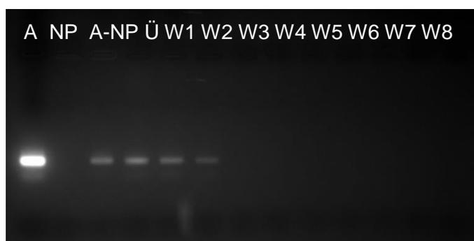
Abbildung 44: Agarose-Gelelektrophorese von Syl3C-PAA@TiO<sub>2</sub> P25 funktionalisierten NP. A=reines Aptamer; NP=PAA@FeWT; A-NP=Syl3C-PAA@FeWT; Ü=Überstand direkt nach der Synthese; W1-8=Waschschrte.
