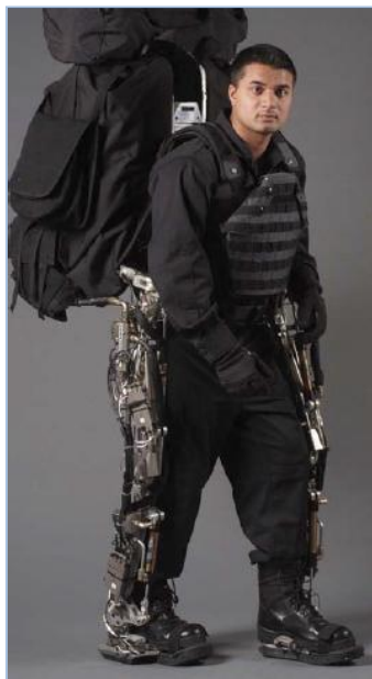
Figure 19—BLEEX exoskeleton (Zoss et al., 2005)
