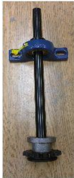
Figure 26: Sprocket for Fan Shaft
