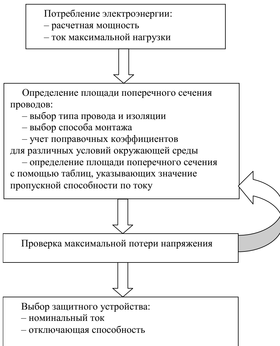
Рис. 1. Логическая схема для выбора сечения кабеля и защитного устройства
