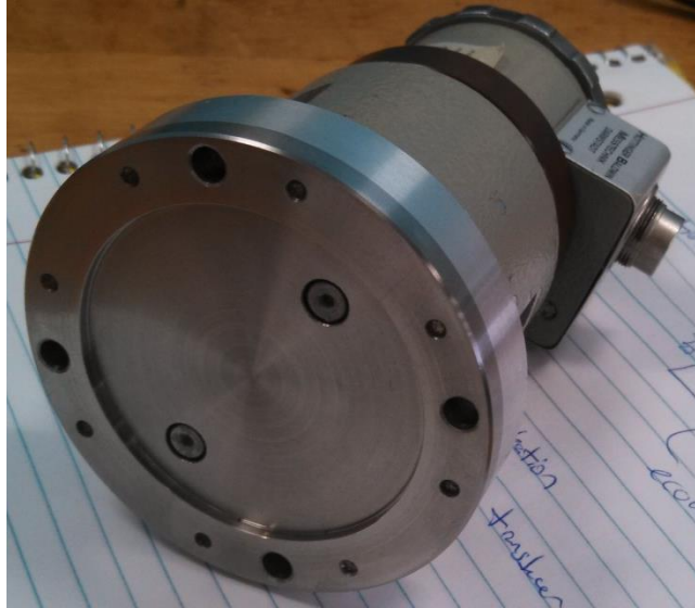
Figure 59 HBM DrehSchwungung Aufnahme Torsional Vibration Transducer
