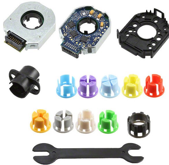
Figure 42: CUI Absolute Encoder (CUI Inc.)
