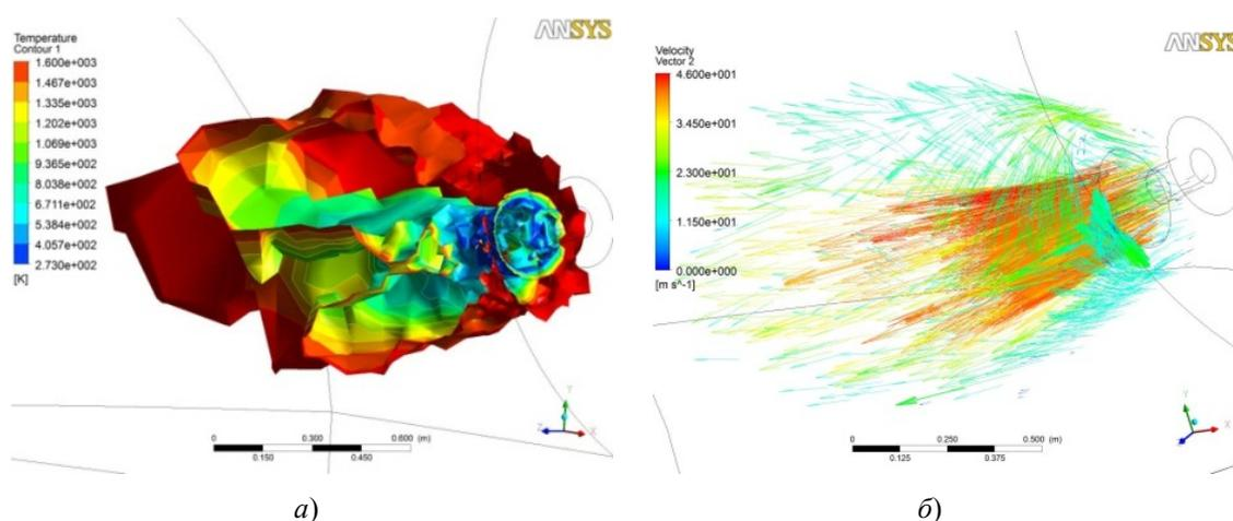
Рис. 2. Результаты моделирования процессов горения:
