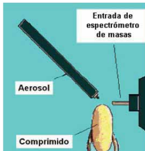
Figura 6. Análisis directo de comprimidos farmacéuticos por DESI-MS
