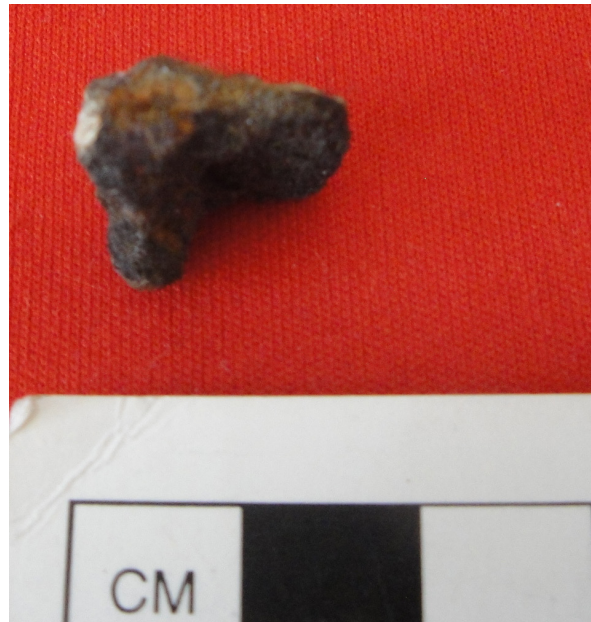
Figura 7. Fragmento compuesto principalmente por hierro, hallado in situ en una cuaderna doble.
