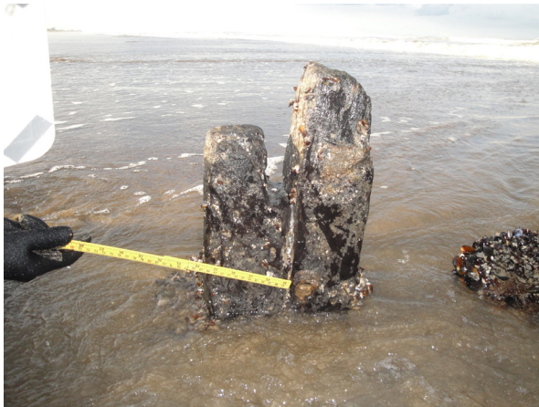
Figura 6. Orificio de clavazón (señalado con el extremo del metro rígido) en una de las cuadernas del sitio. Probablemente corresponda a un elemento ferroso utilizado para la unión entre la cuaderna y el forro externo de la embarcación.
