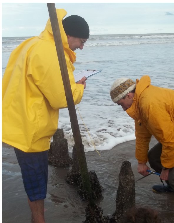
Figura 3. Toma de muestras de madera con barreno de incrementos o de Pressler.
