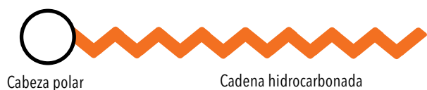
Figura 1. Esquema de una molécula anfifílica típica, por ejemplo, de dodecil sulfonato de sodio, surfactante muy común en gran variedad de preparaciones, como champús o detergentes lavavajilla. La cabeza polar es sulfato de sodio y la cadena hidrocarbonada (usualmente llamada cola) tiene doce carbonos.
