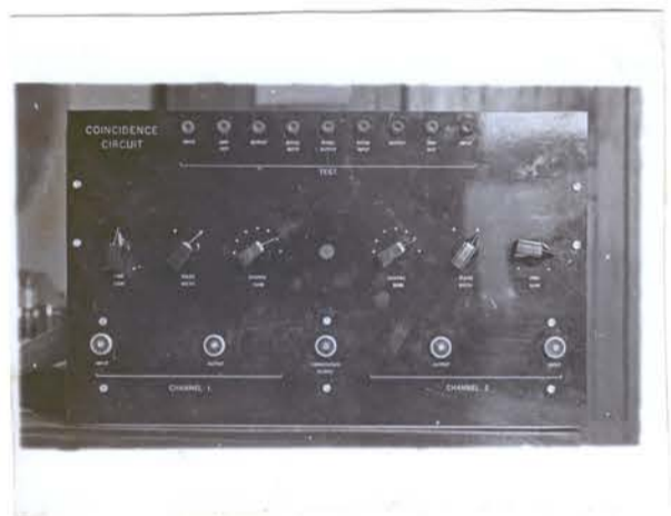
g. COINCIDENCE CIRCUIT.
