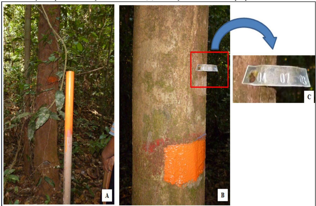
Figura 3 – Na foto (A) mostra o tipo de piquete utilizado na demarcação das parcelas e na foto (B) mostra a marcação do ponto de medição do diâmetro e (C) numeração das árvores com plaquetas de alumínio.
