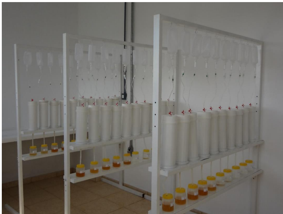
Figura 4. Experimento de dinâmica de liberação de elementos químicos com Colunas de Lixiviação.
