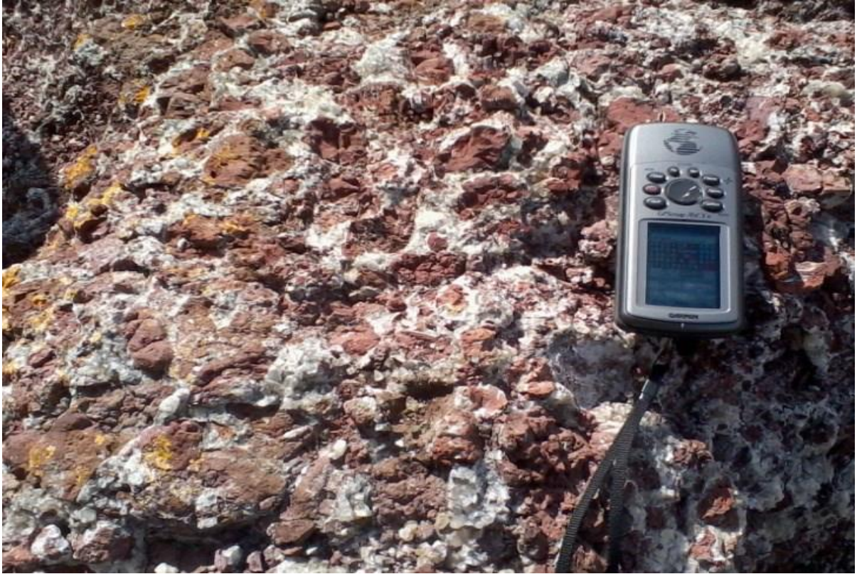
Figura 6. Fotografia de brecha de topo com matriz a calcita (derrame Cordillera), Santana do Livramento/RS (HOFF et al., 2016).
