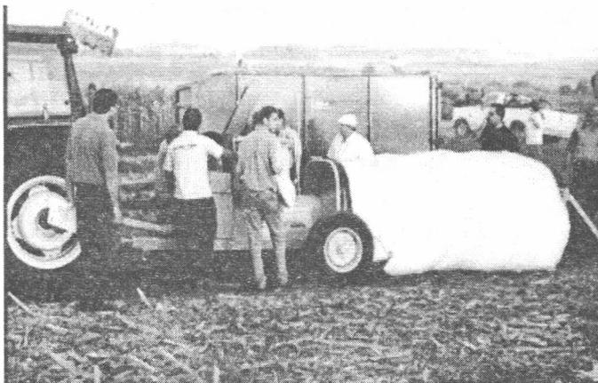
Figura 9. equipamento fazendo o enchimento de um silo tipo tubo
