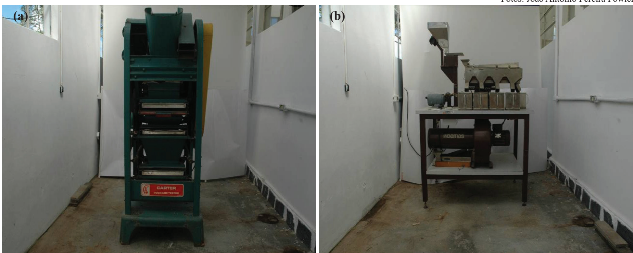
Figura 1. Máquina de ar e peneiras (a) e Mesa de gravidade (b) para beneficiamento de sementes.
