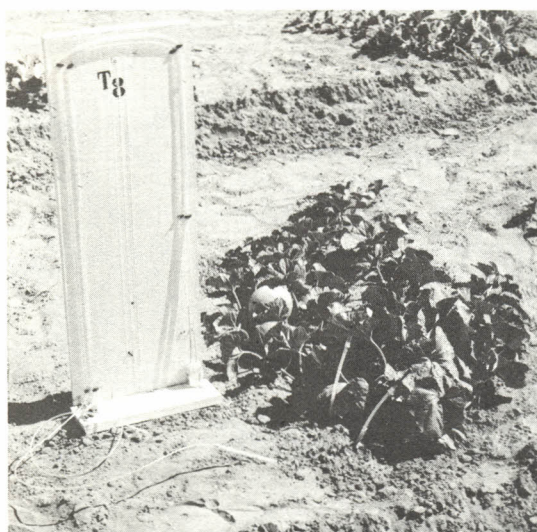
FIG. 5. Tensiômetro de mercúrio para o controle da irrigação.
