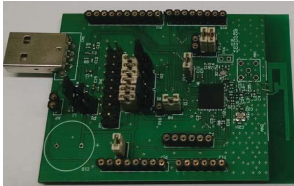
Figura 20. Módulo low power desenvolvido utilizando o SoC CC2538 da Texas Instruments (do autor).
