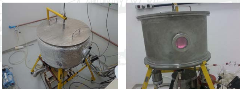
Figura 1. Visão geral do reator de plasma frio (A); Descarga de plasma frio em andamento (B).
