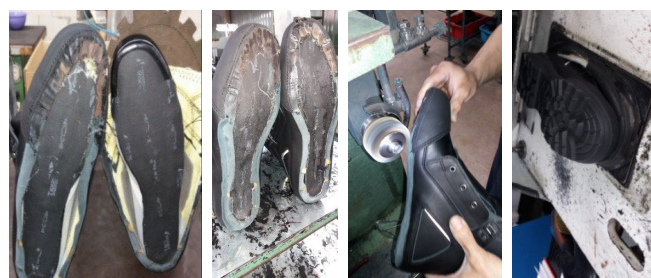
Slika 12 Navlačenje vrška – cvikanje
