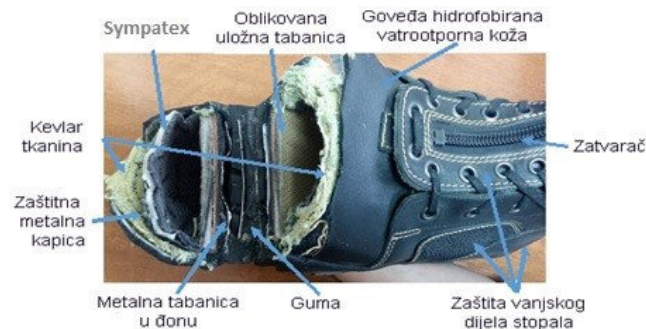
Slika 6. Čizma za šumare prikazana po slojevima
