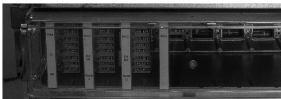
Slika 5. Relejna grupa ovisnosti APB-ŽCP
