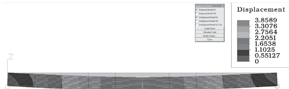
Figure 5 Values of vertical displacement (mm) in plywood model variant II Slika 5. Vrijednosti vertikalnog pomaka (mm) u modelu za furnirsku ploču varijante II.
