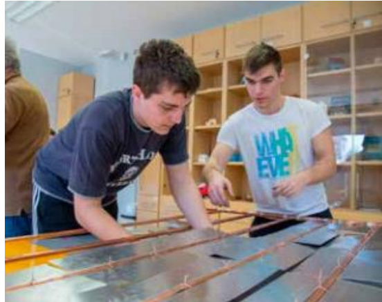
Slika 4. Povezivanje aluminijskih krilca bakrenom žicom
