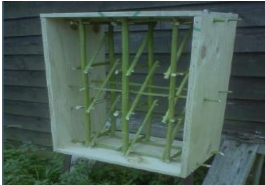
Slika 14. Armirani kalup za konopljin blok (Bell, 2012)
