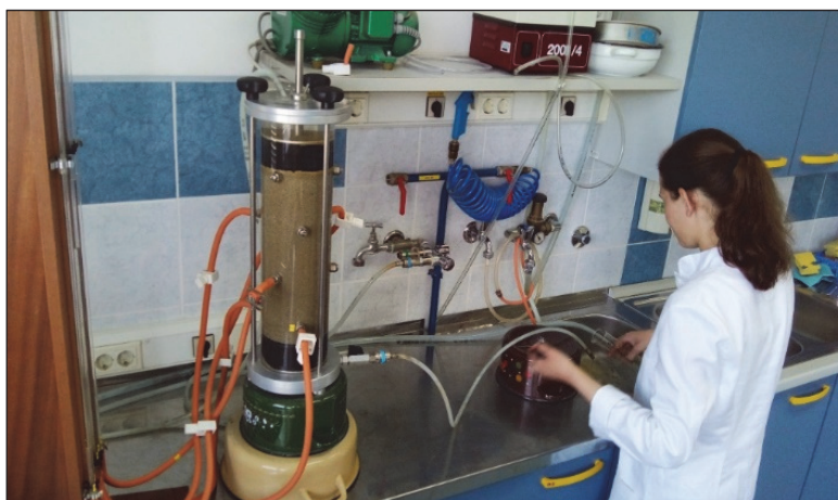
Slika 5. Mjerenje koeficijenta vodopropusnosti u ćeliji permeamtra
