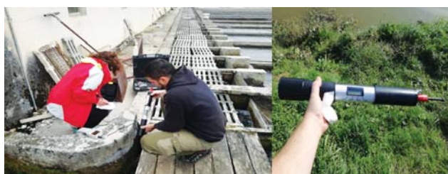
Slika 3: Očitavanje cijanobakterijskih pigmenata terenskom sondom AlgaeTorch na HRZZ projektu AQUAHEALTH (snimio D. Kapetanović)
