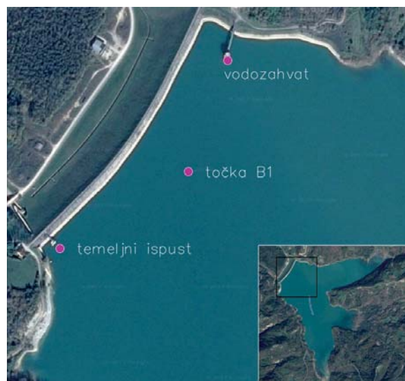
Slika 1: Položaji mjernih položaja na kojima su se 2016. g. vršila uzorkovanja vode u svrhu mjerenja temperature vode i koncentracije različitih suspendiranih tvari. U svrhu kalibracije numeričkog modela su se koristili podatci prikupljeni za točku B1 (kao najreprezentativniju točku za vertikalni raspored temperature vode i masene koncentracije mangana)
