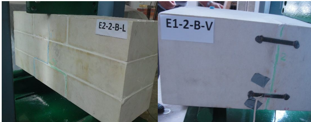
Slika 9. Pojava prvih pukotina u sljubnicama morta
