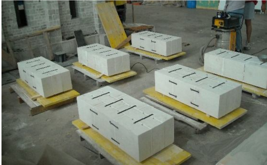
Slika 4. Izrađeni modeli segmenata svoda
