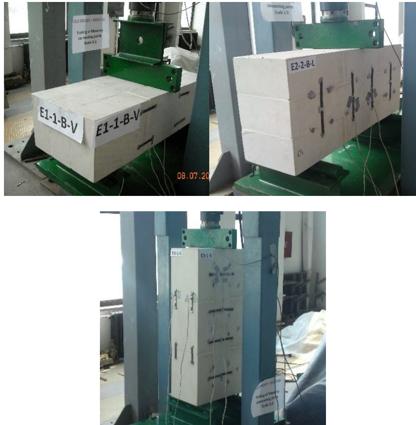
Slika 5. Izgrađeni segmenti zida postavljeni u položaj za ispitivanje
