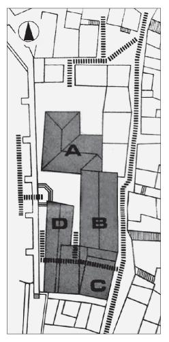
Fig. 4 Renovation and reconstruction project of Cultural Center (1979-82). Site plan — the existing Buildings "A-B", "D" and the interpolated part "C". Sl. 4. Projekt obnove i rekonstrukcije Kulturnog centra (1979.-1982.). Plan lokacije — postojeće zgrade "A-B", "D" i interpolirani dio "C".
