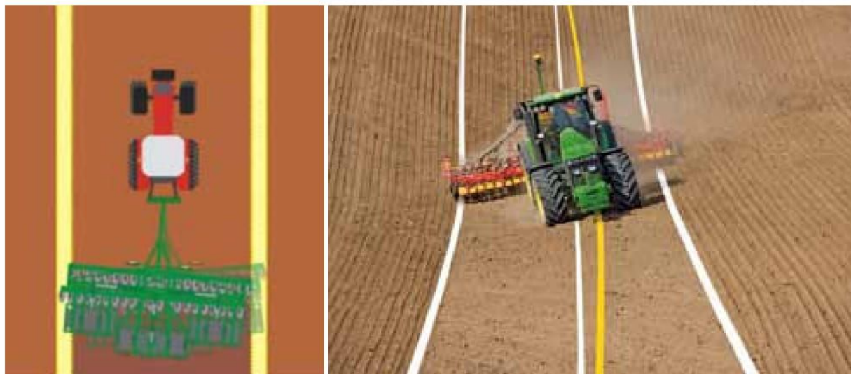
Slika 5. Kontrola podešavanja bočne linije priključka pomoću precizne navigacije
