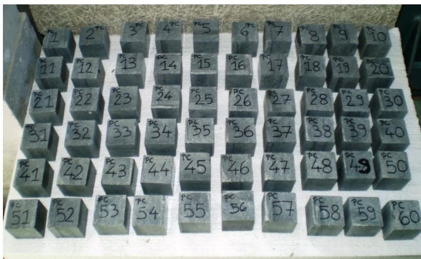
Slika 7. Uzorci gabra iz majdana „Padešnica Crna“ prije ispitivanja
